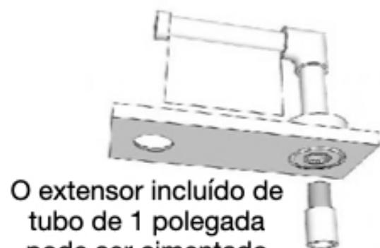
O extensor incluído de tubo de 1 polegada pode ser cimentado e canalizado para sua bomba de água ou estouro de exibição
