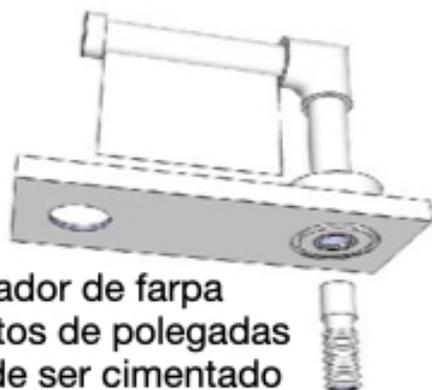
O adaptador de farpa de três quartos de polegadas incluído pode ser cimentado e conectado com uma mangueira flexível à sua bomba de água ou o estouro de exibição
